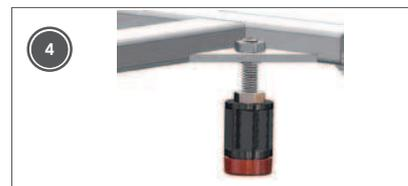
**ÉTAPE 4:** Placer l'écrou puis les ensembles (talon isolant+pièce réglable) en les vissant sur les goujons.
