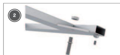
**ÉTAPE 2:** Monter les goujons sur le cadre : a) Visser le goujon sur l'équerre. b) Bloquer avec l'écrou du côté supérieur.
